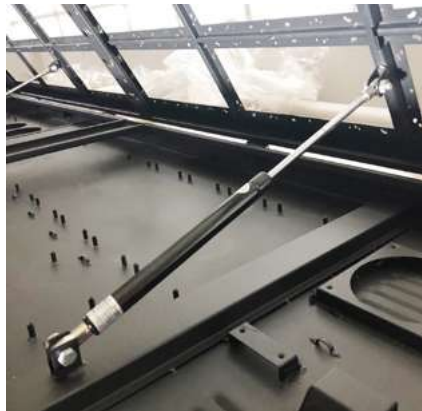
Apertura delantera con sistema de elevación amortiguada
